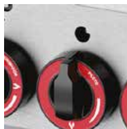
Acesso externo à regulagem de passagem de gás para os pilotos.
